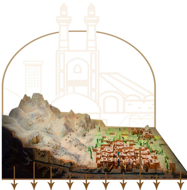
زمین‌های کشاورزی مظهرقنات شهر پایاب آب‌انبار کانال‌قنات آسیای‌آبی میله‌چاه مادچاه سنگجستر شکل (۴): شمای قنات و سازه‌های تاریخی آبی در مسیر آن؛ تصویرسازی: نیلوفر آقاسقای.
