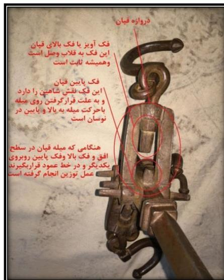
تصویر شماره ۱۰: دروازه قیان (اجزای تشکیل‌دهنده و شیوه کار)
