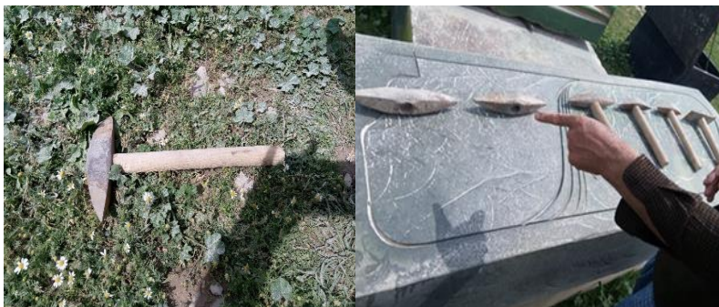
شکل ۲۶- کلنگ سنگتراشی در اندازه‌های مختلف، همان
